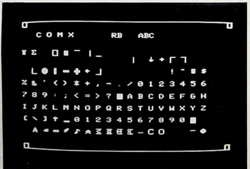
Afb. 3 Standaard aanwezige karakterset in de COMX-35.
