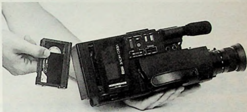
Afb. 13 De Videomovie VHS van Nordmende; een camera met ingebouwde videorecorder en een speeltijd van maar liefst 30 minuten kan wel eens een doorbraak op videogebied betekenen.
